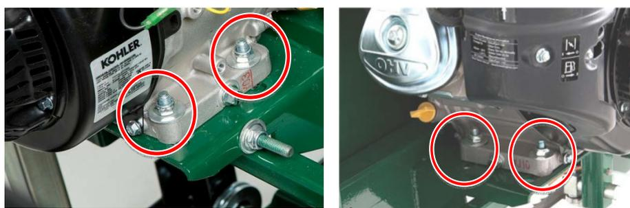
Um den Antriebsriemen auszutauschen, lösen Sie die vier Bolzen, mit denen der Motor an der Motorhalterung befestigt ist, mit einem 16 mm Schlüssel.
