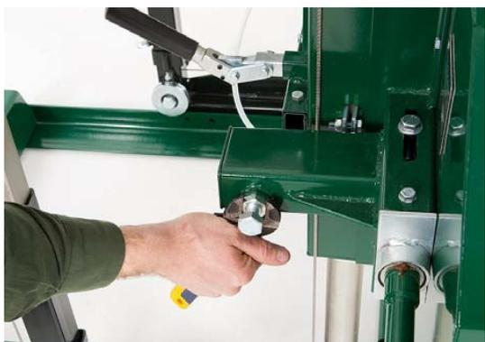
Lösen Sie die Sicherungsmutter der Blattspureinstellung.
