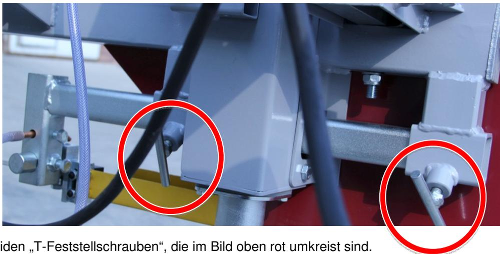
Lösen Sie die beiden „T-Feststellschrauben“, die im Bild oben rot umkreist sind.
