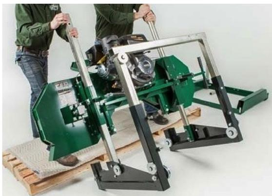
Stellen Sie die Baugruppe mit dem Sägekopf mit einer Person an jeder Stange auf die Rollen, wie in Abbildung oben gezeigt. Heben Sie mit **mindestens zwei Personen** den beweglichen Rahmen zusammen mit dem Sägeaggregat an und legen Sie ihn auf den errichteten Schienenweg ab. Achten Sie dabei darauf, dass die Nuten der Rollen (Schlittenrad) an den Schienen anliegen. Die eckige, vertikale Stange muss sich auf derselben Seite befinden wie die Anschläge.
