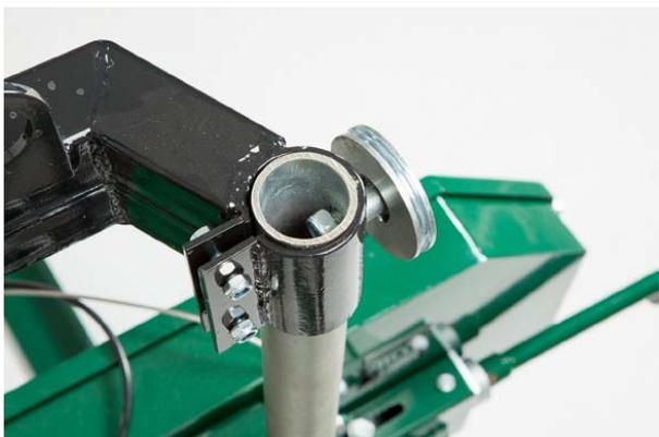
Stecken Sie die Mutter von innen in der runden Stange auf, um das Riemenrad zu befestigen. Halten Sie die Mutter mit einem 16 mm Schlüssel und ziehen Sie den Bolzen fest.
