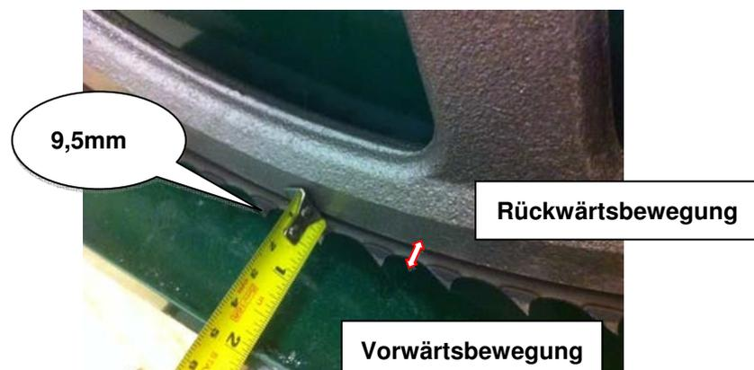
Das Sägeband muss auf beiden Seiten mit demselben Abstand zwischen Zahn und Laufradoberfläche laufen. 9,5 mm sind ideal. Messen Sie den Abstand von der Spitze des Sägebandzahns zur Oberseite des Laufrads auf beiden Seiten. Wenn eine Einstellung auf einer der beiden Seiten erforderlich ist, führen Sie die im Folgenden detailliert beschriebenen Schritte durch.
