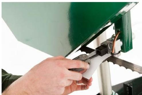
Halten Sie ein Stück Papier zwischen das Sägeband und die Sägebandführungsblöcke und ziehen Sie die Innensechskantschrauben fest.
