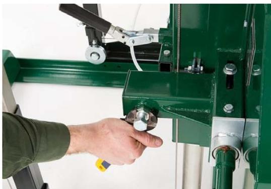
Wenn Sie mit der Messung zufrieden sind, ziehen Sie die Sicherheitsmutter im Uhrzeigersinn fest.
