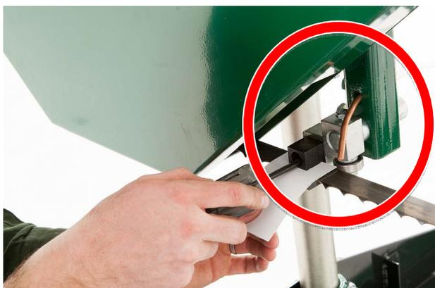
Lösen Sie die Sägebandführungsblöcke auf der linken und rechten Seite mit einem 6 mm Innensechskantschlüssel. Sie sollten sich frei nach oben und unten schieben lassen.
