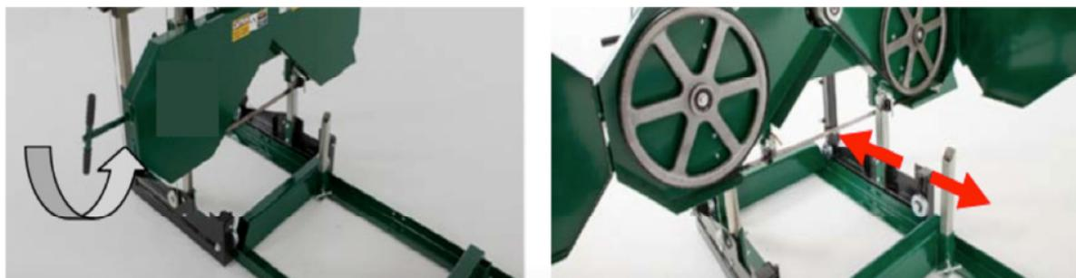
Lösen Sie die Spannung des Sägebands, indem Sie den „T“-Griff gegen den Uhrzeigersinn drehen und öffnen Sie dann die Abdeckung des Sägebandschutzes. Das Sägeband sollte jetzt lose sein und sich direkt von vorne herausziehen lassen.
