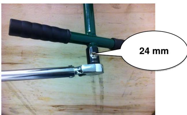
Verwenden Sie den 24 mm Einsatz eines Drehmomentschlüssels, um den „T-Griff“ auf ein Drehmoment von 25 Nm einzustellen. Siehe Bild oben.
