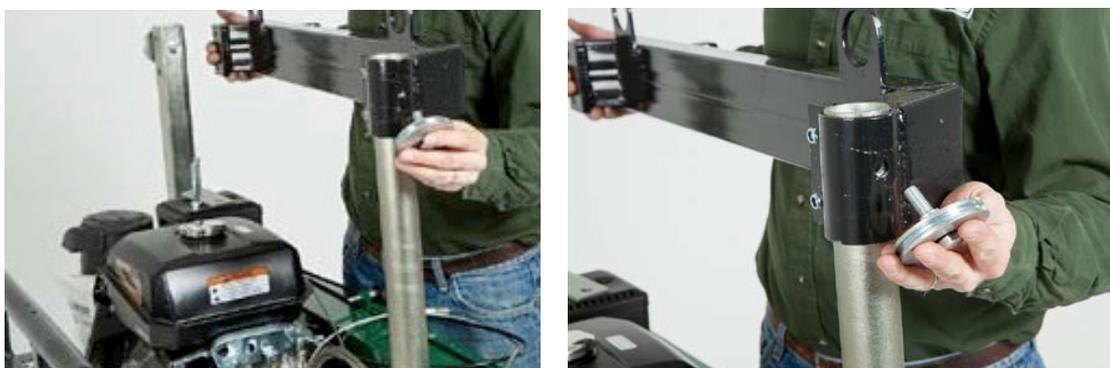
Schieben Sie die obere Querstrebe auf die runde Stange und stecken Sie die Baugruppe aus Riemenrad, Bund und Bolzen in die Bohrung.
