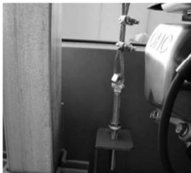
Befestigen Sie die Kabelbolzen an den Halterungen am Kopf des Bandsägewerks, wie oben gezeigt. Es ist am besten, das Sägeaggregat des Bandsägewerks ganz nach unten abzusenken. Stellen Sie danach die beiden Bolzen so ein, dass das Sägeaggregat mit den Querstreben der Schienen auf einer Ebene liegt. In den folgenden Abschnitten finden Sie weitere Details zu diesem Aufbau.
