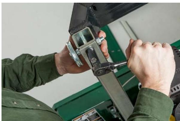
Stecken Sie die Bolzen in die Rückplatte, wie in der Abbildung links oben gezeigt. Richten Sie die Bohrungen in der eckigen Stange an den entsprechenden Bohrungen der schwarzen oberen Querstrebe aus. Die Bolzen mit einem 18 mm Schlüssel festziehen.
