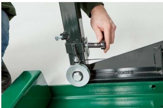
Bringen Sie die vier Reiniger so am Rahmen an, dass die Stahlbürste den Boden der Nute in den Schlittenrädern erreicht. Verwenden Sie zur Befestigung einen 13 mm Schlüssel.
