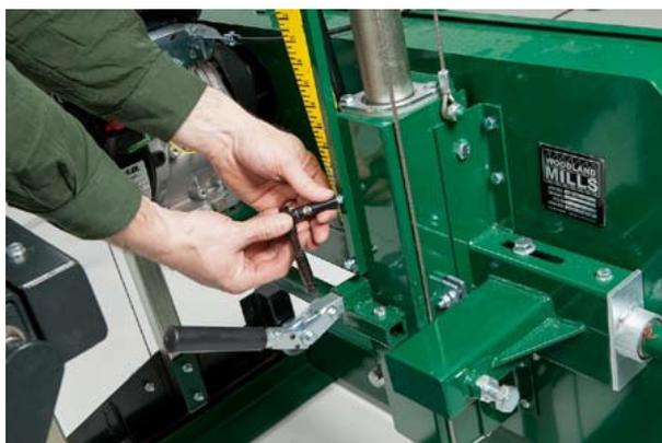
Bauen Sie den rechteckigen Anzeigestab mithilfe der beiden Bolzen in die Bandsäge ein und ziehen Sie ihn mit einem 10 mm Schlüssel fest.
