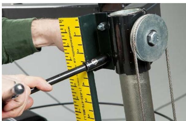
Platzieren Sie die Messskalenhalterung wie oben gezeigt und befestigen Sie sie mit den Schrauben und Muttern. Es ist wichtig die Muttern abwechselnd festzuziehen (oben, dann unten), um sicherzustellen, dass die schwarze, runde Klemme oben und unten einen gleichmäßigen Druck aufbaut, bis die Flansche sich am Außenrand treffen. Mit einem 13 mm Schlüssel festziehen.
