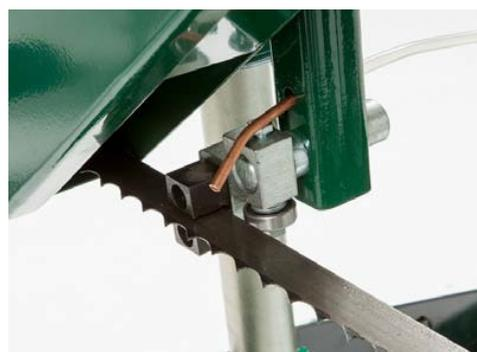
Setzen Sie den Kühlmittelbehälter in die Halterung ein. Führen Sie die Leitung des Kühlmittelbehälters durch die Bohrung an der Unterseite des Sägekopfes, wie oben gezeigt. Verwenden Sie einen 16 mm Schlüssel, um das Kupferende zu fixieren. Ziehen Sie das Kupferende nicht zu fest an und quetschen Sie es nicht.
