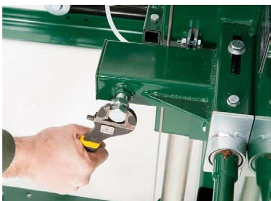
Der Einstellungsbolzen kann jetzt gedreht werden, um den Winkel des Laufrads zu ändern und den Blattspurlauf einzustellen. Um das Sägeband auf dem Laufrad rückwärts zu bewegen, muss dieser Bolzen im Uhrzeigersinn gedreht werden. Alternativ würde eine Drehung des Bolzens gegen den Uhrzeigersinn das Sägeband dazu bringen sich auf dem Laufrad weiter nach vorn zu bewegen. Drehen Sie den Bolzen um eine halbe Drehung und spannen Sie das Sägeband wieder.
