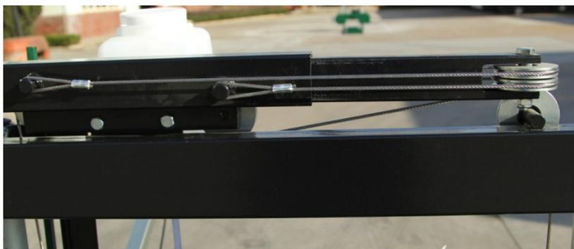
Befestigen Sie die Kabel an den Riemenrädern, wie oben gezeigt.
