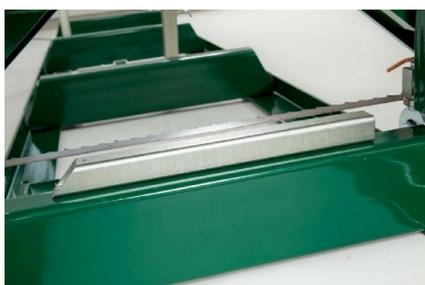
Messen Sie mit einem Maßband den Abstand der linken und rechten Seite vom Sägeband zur Oberseite der Auflagefläche/Querstrebe. Der Abstand muss auf beiden Seiten gleich sein. Ist dies nicht der Fall, müssen Sie die Kabelbolzen nach oben oder unten einstellen, um den Sägekopf an einer Seite zu heben oder zu senken, bis das Messergebnis auf beiden Seiten gleich ist.
