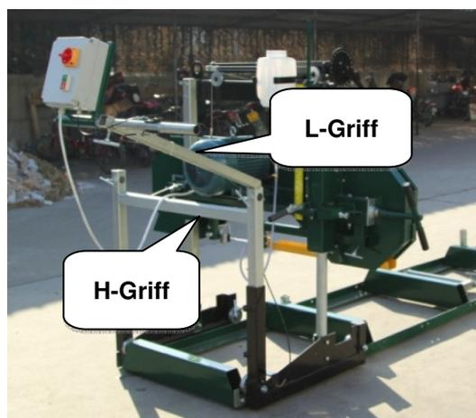
Stecken Sie das H-Griffstück in die vertikalen Stangen des Sägeschlittens. Stecken Sie den „L-Griff“ in die rechte vertikale Stange. Stellen Sie die Höhe der Griffe ein und verriegeln Sie sie mit den T-Bolzen. Bitte beachten Sie das Bild oben.
