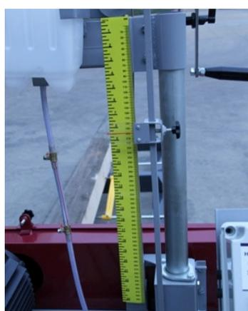
Stellen Sie die Höhe des Schneidekopfes des Bandsägewerks durch Drehen der Kurbel auf die geeignete Höhe ein.
