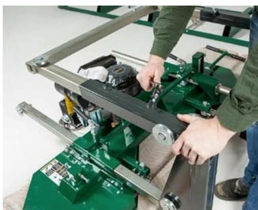
Stecken Sie den hinteren rechteckigen Rahmen in das Fußteil des Sägeschlittens, bis er auf den Riemenradbolzen aufsitzt. Sichern Sie den Rahmen, indem Sie die vier 16 mm Bolzen (in der rechten Abbildung gezeigt) gut festziehen.
