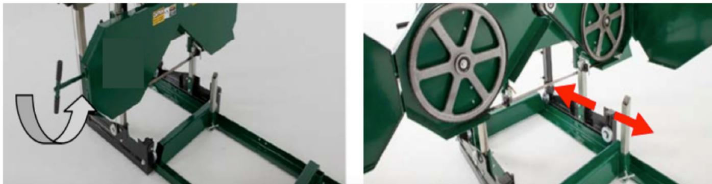
Lösen Sie die Sägebandspannung, indem Sie den „T“-Griff gegen den Uhrzeigersinn drehen und öffnen Sie dann die Abdeckung des Sägebandschutzes. Das Sägeband sollte jetzt lose sein und sich von vorne herausziehen lassen. Anschließend kann das neue Sägeband eingebaut, die Schutzeinrichtungen geschlossen und die richtige Sägebandspannung eingestellt werden.
