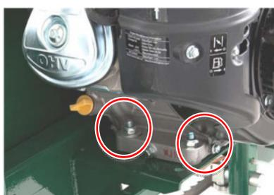
Um den Antriebsriemen zu spannen, lösen Sie zuerst die vier Bolzen, mit denen der Motor an der Motorhalterung befestigt ist, mit einem 16 mm Schlüssel.
