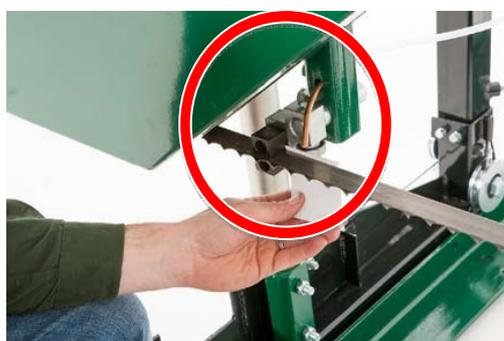
Lösen Sie den Bolzen der Sägebandführungsbaugruppe mit einem 16 mm Schlüssel. Die Rundwelle sollte sich jetzt frei vor und zurück schieben lassen. Positionieren Sie sie so, dass ein papierdicker Abstand zwischen dem Lager und der Rückseite des Sägebands entsteht. Ziehen Sie den Bolzen gegen die Fläche an der Welle, um die Baugruppe wieder zu fixieren.
