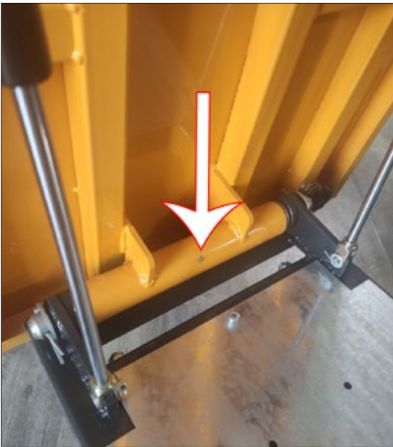
Den Schmiernippel alle 20 Betriebsstunden nachschmieren.
