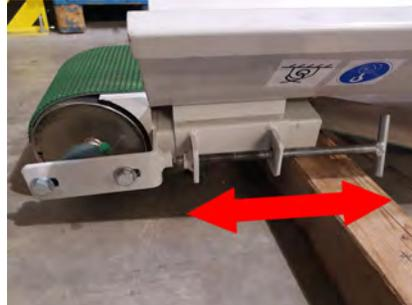
11. Spannen oder entspannen Sie nun den Förderriemen mittels der Spannrolle. Drehen Sie hierzu die Spannschrauben nach links zum Entspannen und nach rechts zum Spannen.
