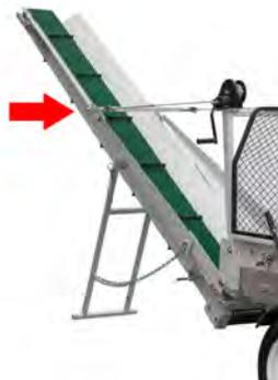
13. Verbinden Sie abschließend den Förderbandhebebügel am Förderband mittels der beiden Schrauben. Die Halterung befindet sich mittig am Förderband.
