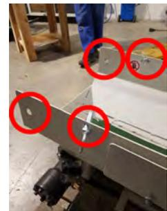
12. Montieren Sie nun mittels 2 Mann das fertig montierte Förderband an den Sägespaltautomaten mittels 2 Schrauben und sichern diese mit 2 Splinten im hochgeklapptem Zustand. (Siehe Bild)
