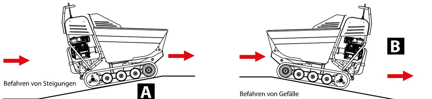
Bei stark abschüssigem Gelände muss der Motor bei voller Leistung laufen (um der Neigung entgegenzuwirken), wobei die Steuerhebel (A + B) nur minimal leicht geöffnet sein dürfen; ansonsten könnten Kavitationsproblem und ein Ausfall des Motorbremseffekts auftreten. Sollte die Maschine von selbst beschleunigen, dann lassen Sie bitte die Steuerhebel aus.
