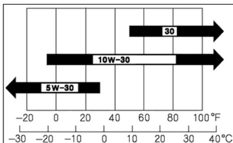
**Handelsübliches Motorenöl mit der Spezifikation 10W-30 oder 10W-40 verwenden. Niemals Öl für Zweitaktmotoren verwenden.**
