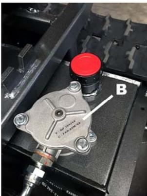
Hydrauliköltank / Rücklauffilter (B)
