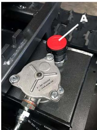
Hydrauliköltank / Verschlusskappe (A)
