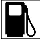
Tanken Sie ausschließlich bleifreies Qualitätsbenzin ROZ 95 oder höher bzw. Diesel bei den Modellen VH500/D und VH500PRO/D. Auf keinen Fall die Maschine mit 2-Takt-Gemisch oder nicht zugelassene Kraftstoffe betanken.
