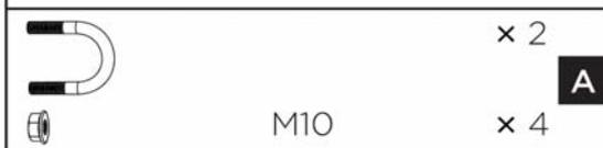
1. Befestigen Sie die Radachse mit Bügelschrauben und Feststellmuttern an dem Spalter.
