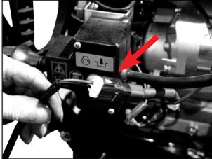
1. Stecker „WEISS“ der elektrische Anlage mit Stecker „SCHWARZ“ der Lichtmaschine zusammenschließen.
