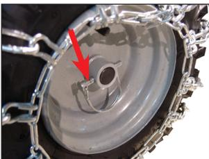
Rad auf die Achse aufstecken und mit einem Klappsplint sichern.
