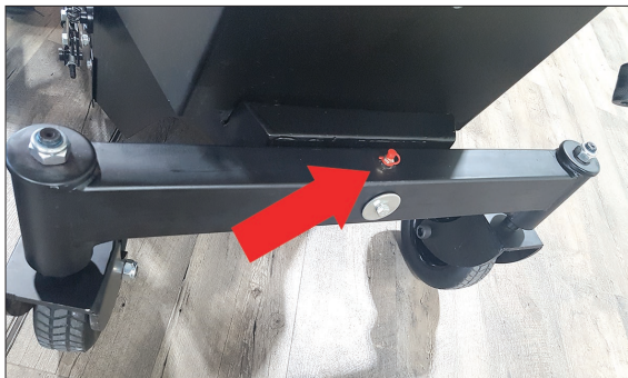
Den Drehpunkt der Pendelachse alle 80 Betriebsstunden nachschmieren.
