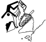
Zu Böschungen und Überhängen ausreichend Abstand halten. Sonst besteht die Gefahr, dass diese einbrechen bzw. abrutschen.
