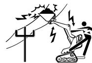
Halten Sie die Maschine und eventuell vorhandene Anbaugeräte in einem ausreichenden Abstand zu allen Stromkabeln, Freileitungen oder anderen Hindernissen.
